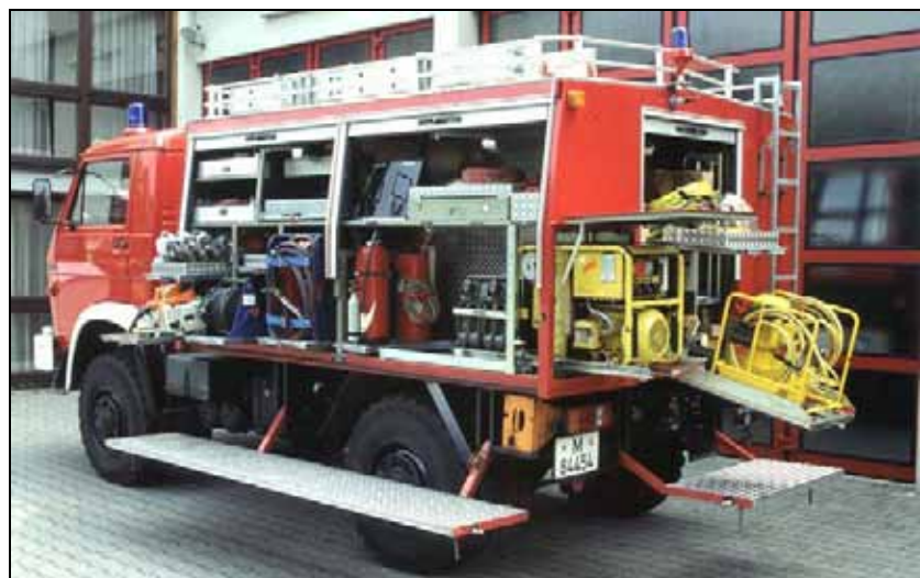
Die umfangreiche Aus- rüstung des RW 1 (später sogar ergänzt durch ei- nen Eigenbau-Lichtmast)
