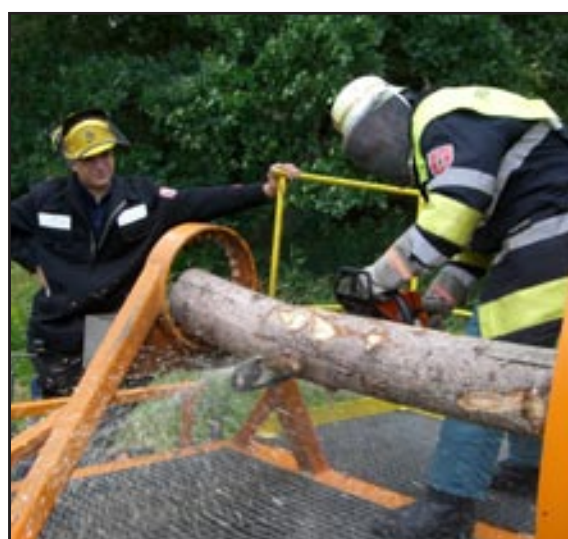
Mit dem Spannungssimulator können die unterschiedlichen Spannungsarten in Baumstämmen simuliert werden
