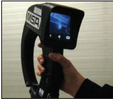
Die WBK ist ein wichtiges Hilfsmittel beim Brandeinsatz
