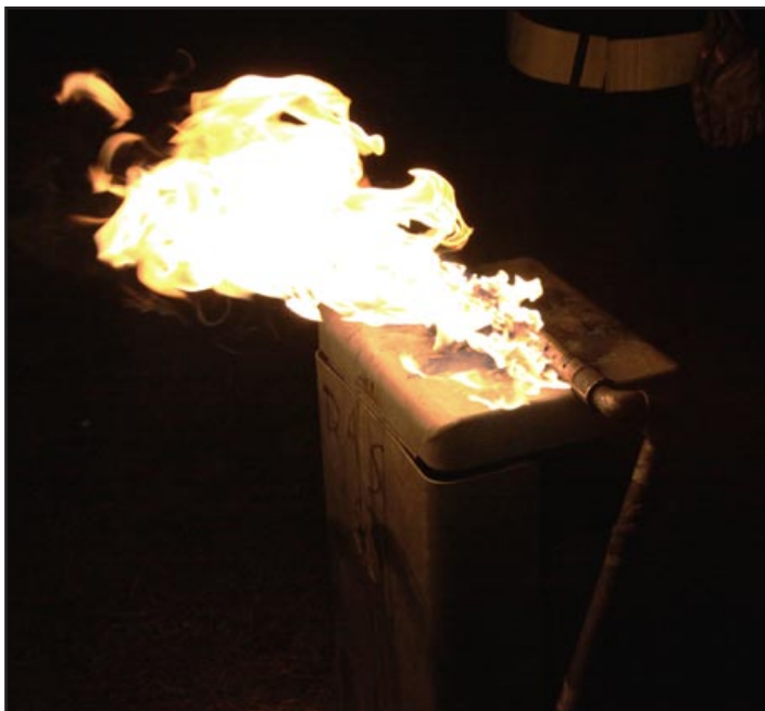
Gaslanze zur Simulation eines Abfalltonnenbrandes
