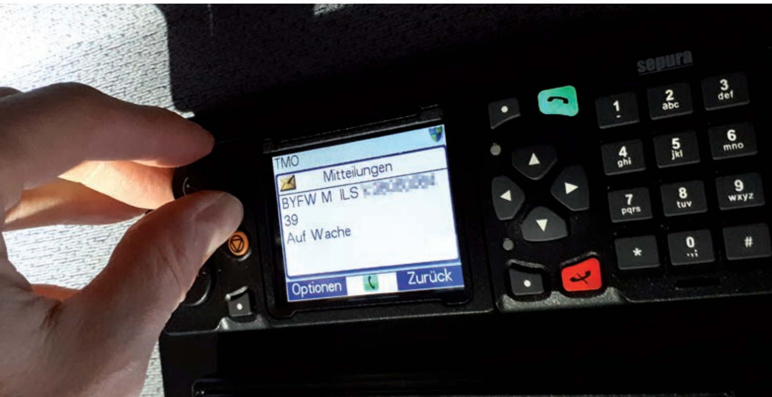
Das Bedienteil eines Fahrzeug-Funkgerätes
